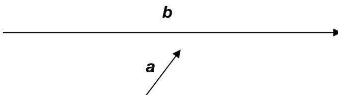
4. Rozložte daný vektor na dvě kolmé složky  $F_1$ ,  $F_2$ . Vyjádřete složky použitím hodnoty původního vektoru a goniometrické funkce úhlu.
