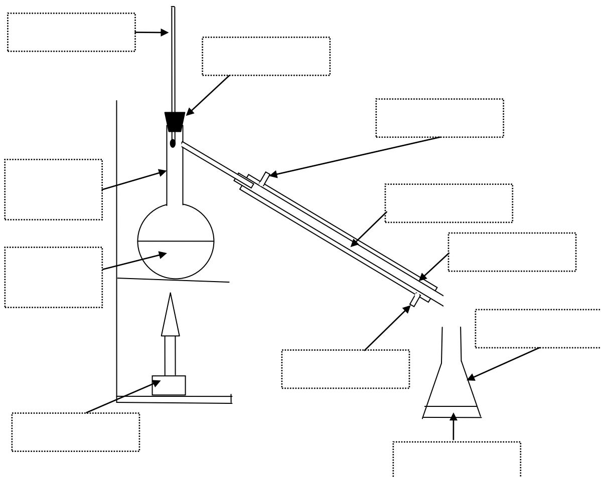
5. Přidejte popisky k jednotlivým částem destilační aparatury: DESTILÁT, ZÁTKA, TEPLOMĚR, CHLADIČ, VARNÁ BAŇKA, KAHAN, SMĚS, STUDENÁ VODA, VODA Z KOHOUTKU, VODA DO VÝLEVKY, JÍMADLO.
